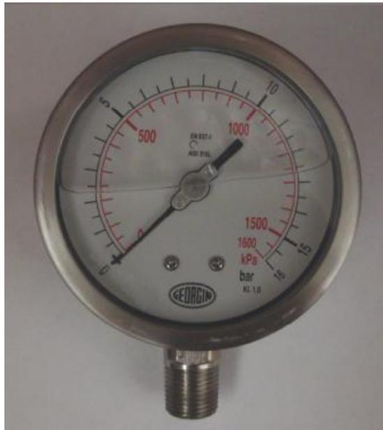
Рисунок 1. Манометр показывающий М5000.
